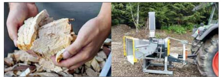
Abbildung 1 „Effits“ aus Energierundholz Fichte (links) und „Effiter 20.30“ (rechts) Fotos: Tobias Hase, StMELF
