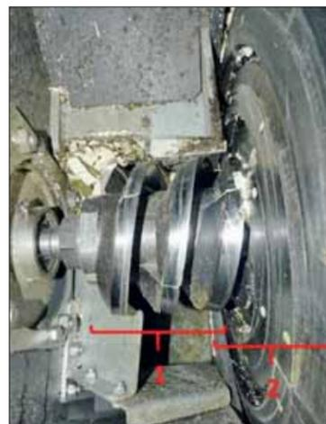
Abbildung 2 Duplex-Schnecke des „Effiters 20.30“ mit der Zylinderschnecke links (1) und der Planschnecke rechts (2) aus Sicht der Revisionsklappe
