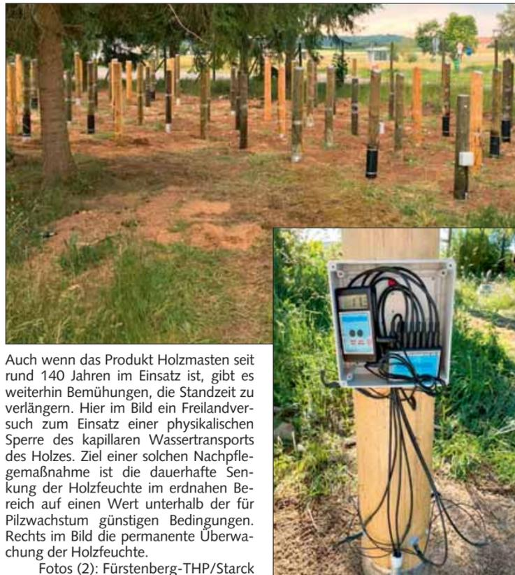
Auch wenn das Produkt Holzmasten seit rund 140 Jahren im Einsatz ist, gibt es weiterhin Bemühungen, die Standzeit zu verlängern. Hier im Bild ein Freilandversuch zum Einsatz einer physikalischen Sperre des kapillaren Wassertransports des Holzes. Ziel einer solchen Nachpflegemaßnahme ist die dauerhafte Senkung der Holzfeuchte im erdnahen Bereich auf einen Wert unterhalb der für Pilzwachstum günstigen Bedingungen. Rechts im Bild die permanente Überwachung der Holzfeuchte.
